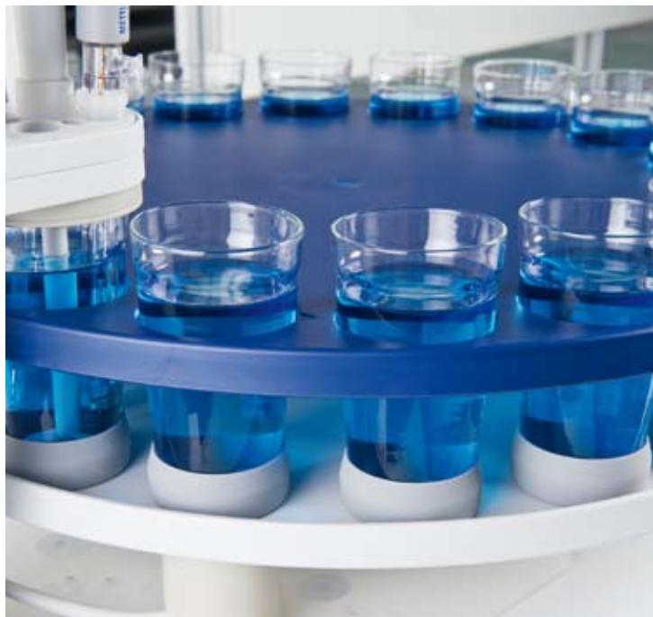
配有SmartSample RFID阅读器的InMotion Flex自动进样器及装在杯套中的滴定杯。
