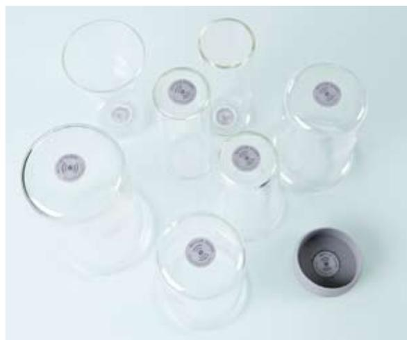
各种滴定杯和SmartSample杯套上的Smart-Tag智能标签
