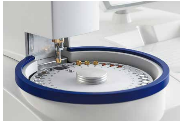
图5：自动进样器抓取几种不同坩埚
