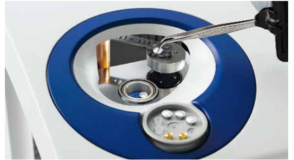
图4：手动加样至DSC炉体
