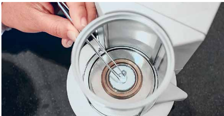
图2：DSC测试样品在微量天平上称重
