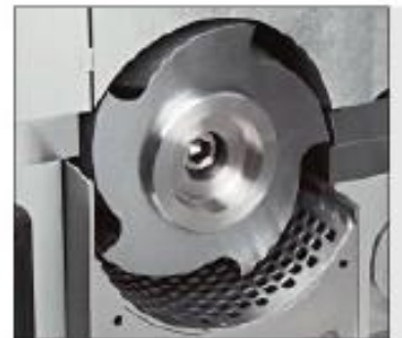
研磨舱室无死角，确保样品高效破碎以及清洗
