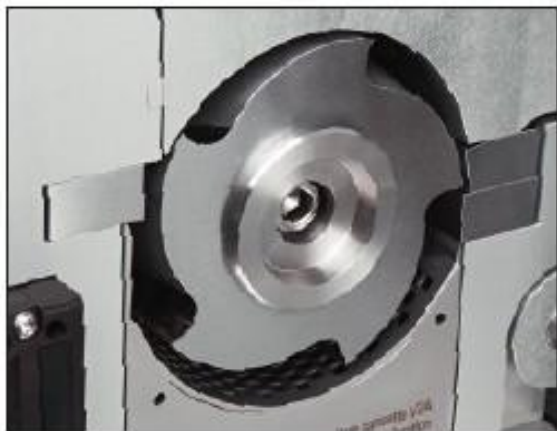
转子与固定刀片之间的渐进式切割，确保更快的粉碎和保护不受堵塞。
