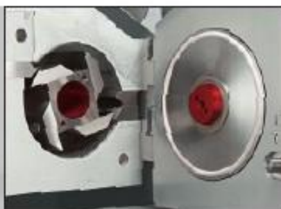
十分稳定：转子主轴和盖子上安装有双列轴承
