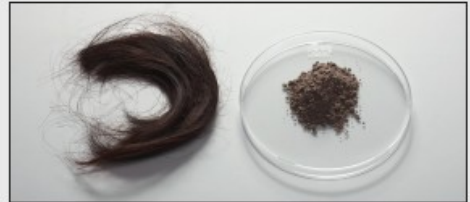
使用 FRITSCH PULVERISETTE 23 进行头发样品研磨的之前和之后
