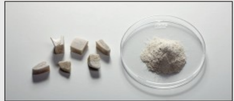
使用 FRITSCH PULVERISETTE 0 进行骨骼研磨的之前和之后
