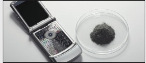
移动电话键盘：冷冻脆化条件下研磨效果
