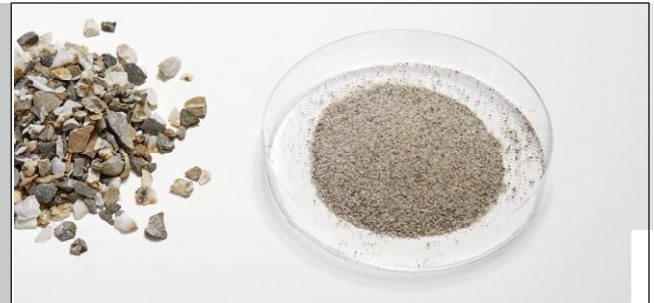
使用交叉搅拌研磨机 PULVERISSETTE 16 研磨石头之前和之后的状态
